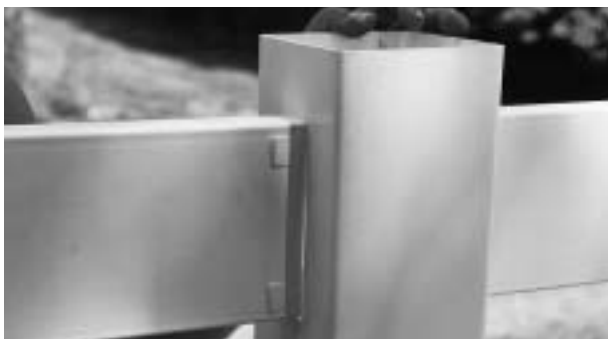
As travessas Country Estate usam travas em cunha para permitir a expansão sem o desencaixe depois de empurradas através das aberturas da coluna recortada.
